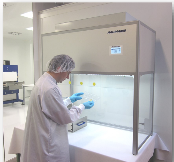
HAG-TTLF: Table Top Laminar Flow mit integrierter Siegelmaschine als kompaktes Reinraum-Verpackungssystem
