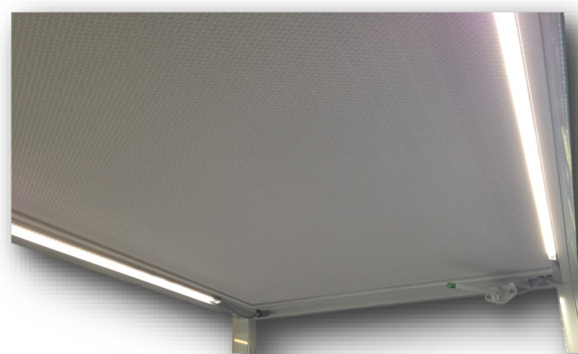
Integrierte LED-Beleuchtung und Strömungsmesssonde
